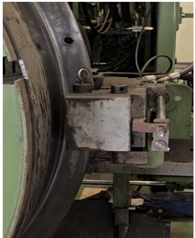
그림 7 플랜지 성형 후 punching 작업
