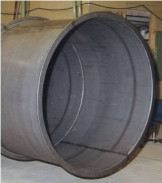
그림4 After Flanging- 플랜징 성형 후 제품
